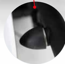
Stabiler Schutz vor Beschädigung der Hecktüren
