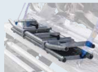
Auffahrrampe sicher verstaut
