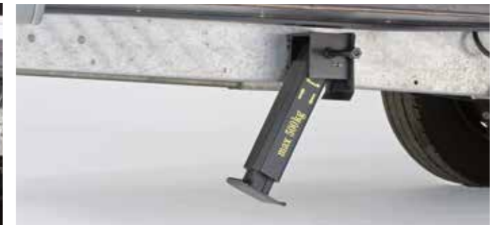
Kurbeln bis Stütze senkrechte Position hat
