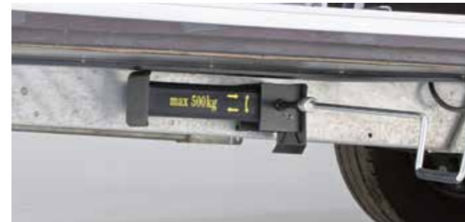
Kurbel auf Sechskant setzen und Kurbeln
