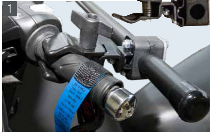
1 Befestigung des Haltearmes mit Kreuzklammer am Lenker
